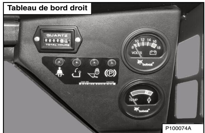
Vérifiez fréquemment les jauges de température et les témoins BICS [Figure 53]. Tous les témoins BICS doivent être éteints pour utiliser la chargeuse. (Voir DISPOSITIF DE VERROUILLAGE BOBCAT (BICS) en page 77.)
