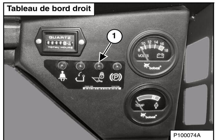
Enfoncez le bouton PRESS TO OPERATE LOADER (1) [Figure 51] pour activer le système BICS et les fonctions hydrauliques de la machine. Le témoin de levage et de cavage (1) [Figure 52] s'ÉTEINT lorsque le système BICS est actif.
