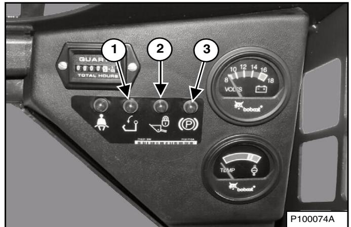
Les trois témoins (1, 2 et 3) [Figure 14] du tableau de bord droit doivent être ÉTEINTS pour utiliser la machine avec toutes ses fonctions.
