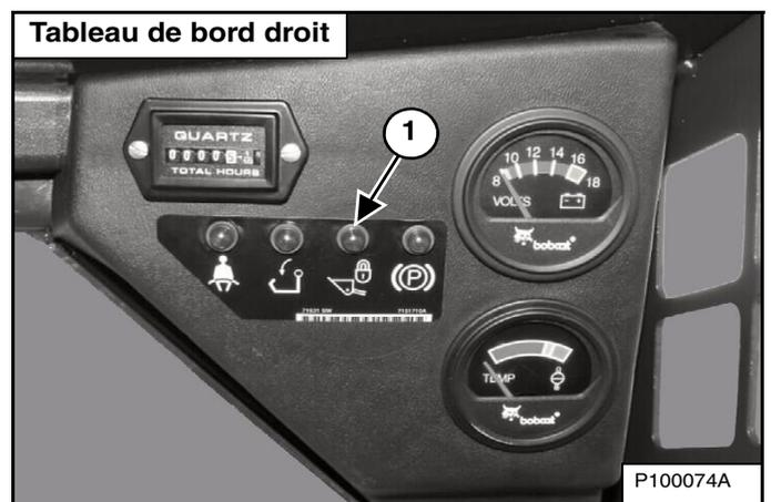
Enfoncez le bouton PRESS TO OPERATE LOADER (1) [Figure 46] pour activer le système BICS et les fonctions hydrauliques de la machine. Le témoin de levage et de cavage (1) [Figure 47] s'ÉTEINT lorsque le système BICS est actif.
