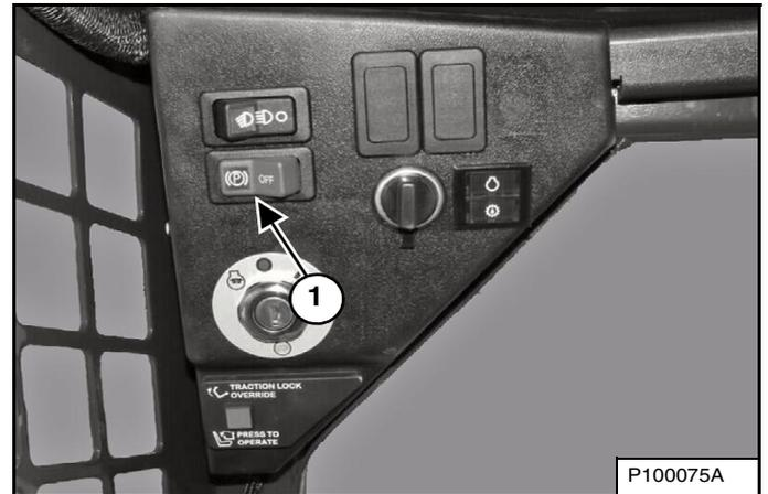
Enclenchez le frein de stationnement en appuyant sur le côté gauche du contacteur (1) [Figure 16]. Le témoin rouge du contacteur s'allume. La transmission est verrouillée.
